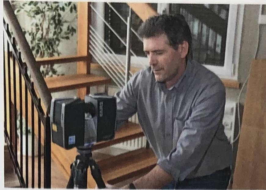
Der Faro Laser Scanner sorgt für ein schnelles Aufmaß vor Ort für die optimale Einpassung
