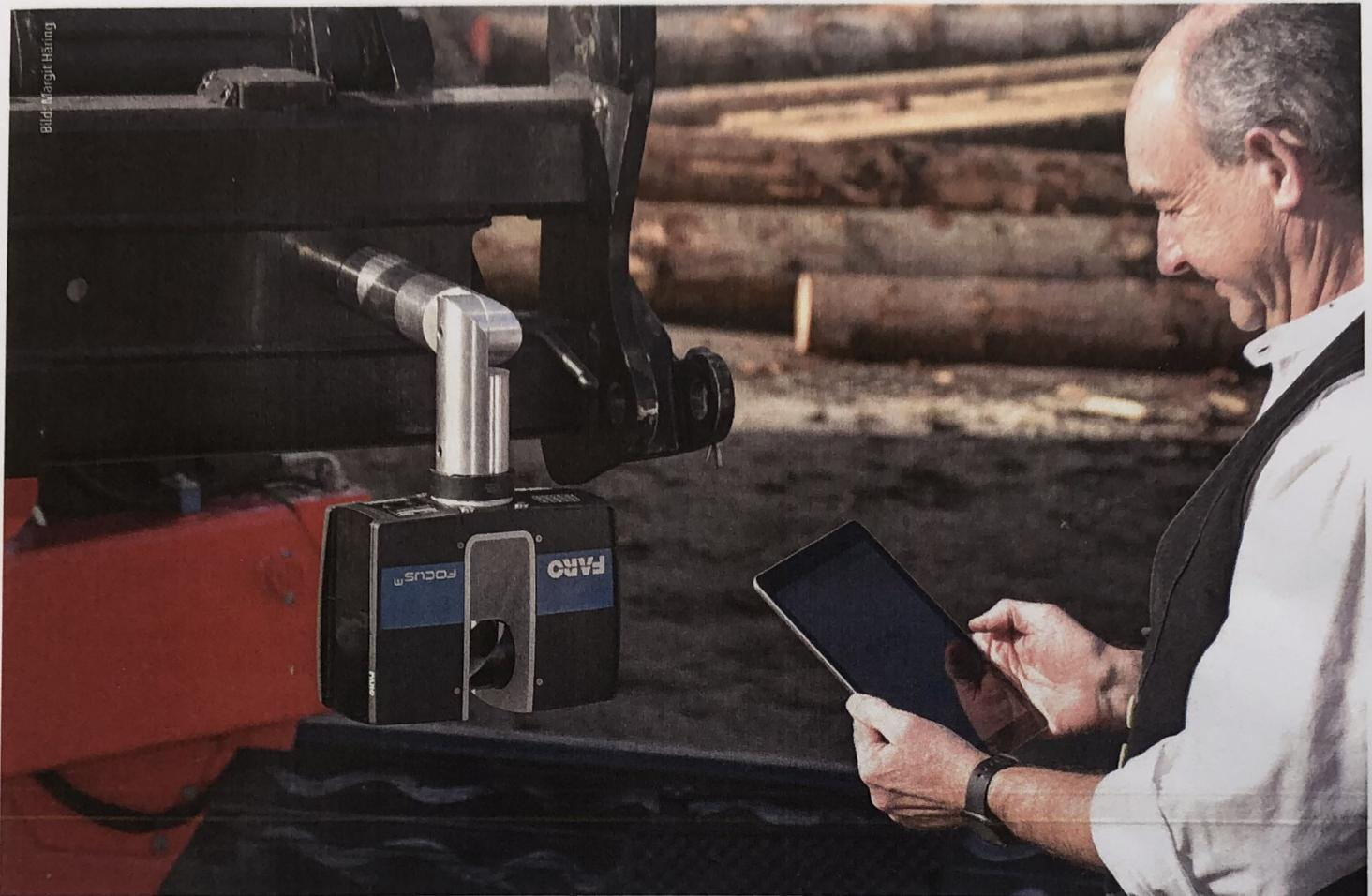
Damit Hans Häring den Laserscanner am Teleskoparm befestigen kann, hat er eine Konstruktion mit Adapter entwickelt.
